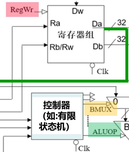
下个时钟开始，在控制器生成的控制信号控制下执行指令。
