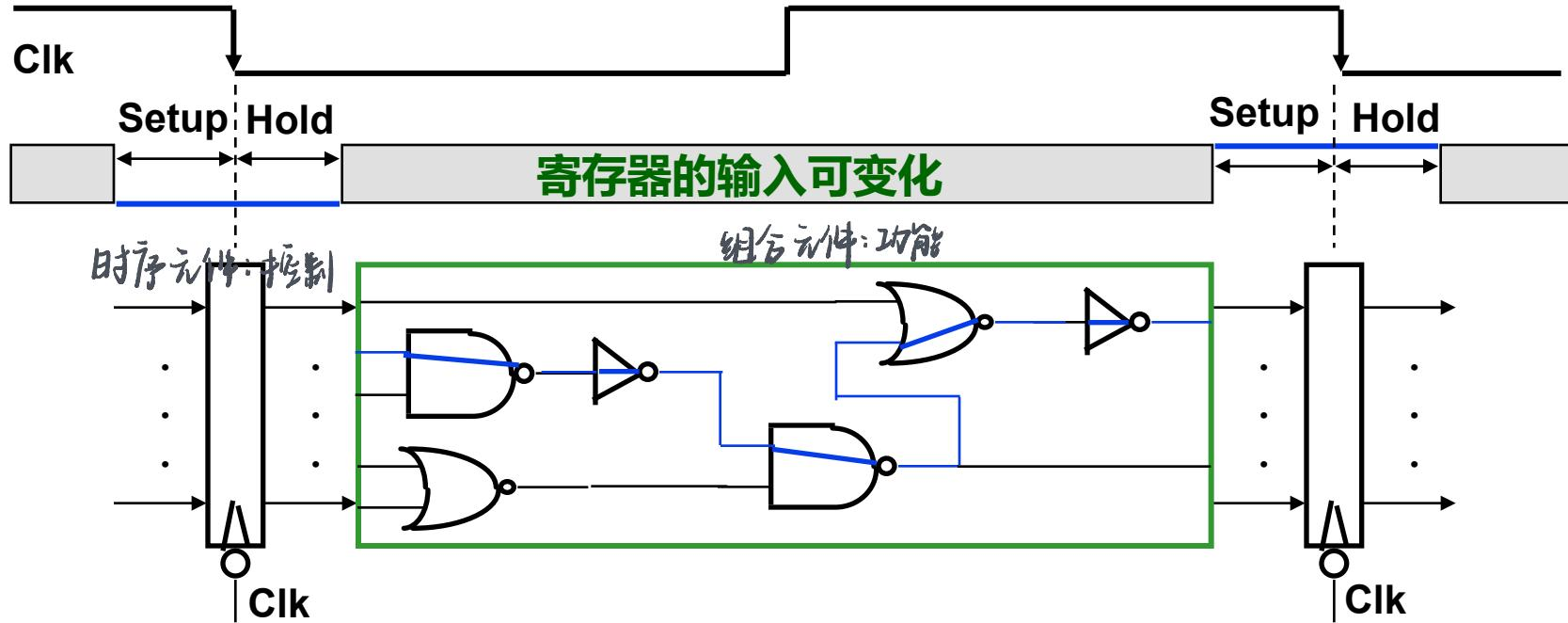
**数据通路由 “... + 状态元件 + 操作元件(组合电路) + 状态元件 + ...” 组成**
