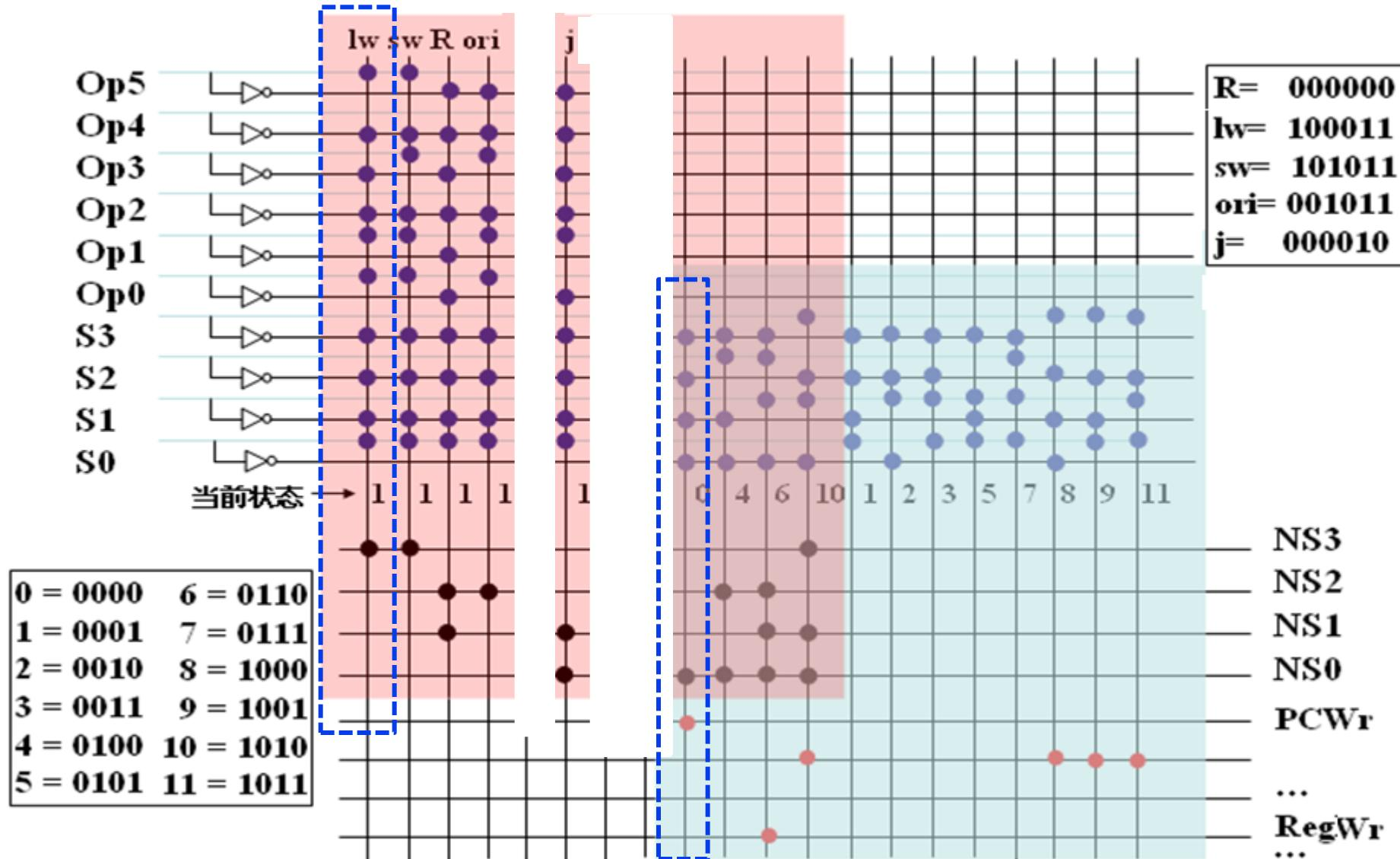
**左上角：由操作码和当前状态确定下一状态的电路**
