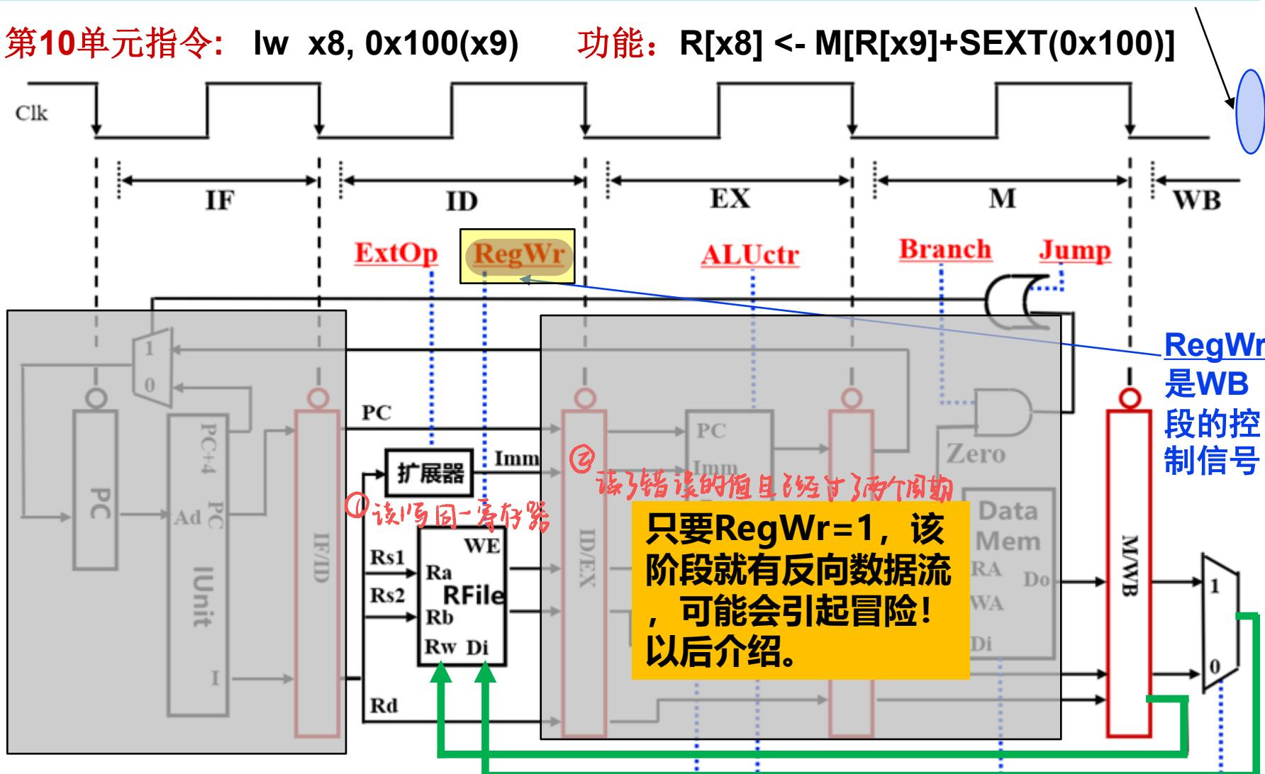
Load控制信号: MemtoReg=1、RegWr=1。
