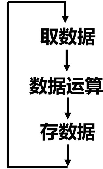
数据通路是由操作元件和存储元件通过总线方式或分散方式连接而成的进行数据存储、处理、传送的路径。
