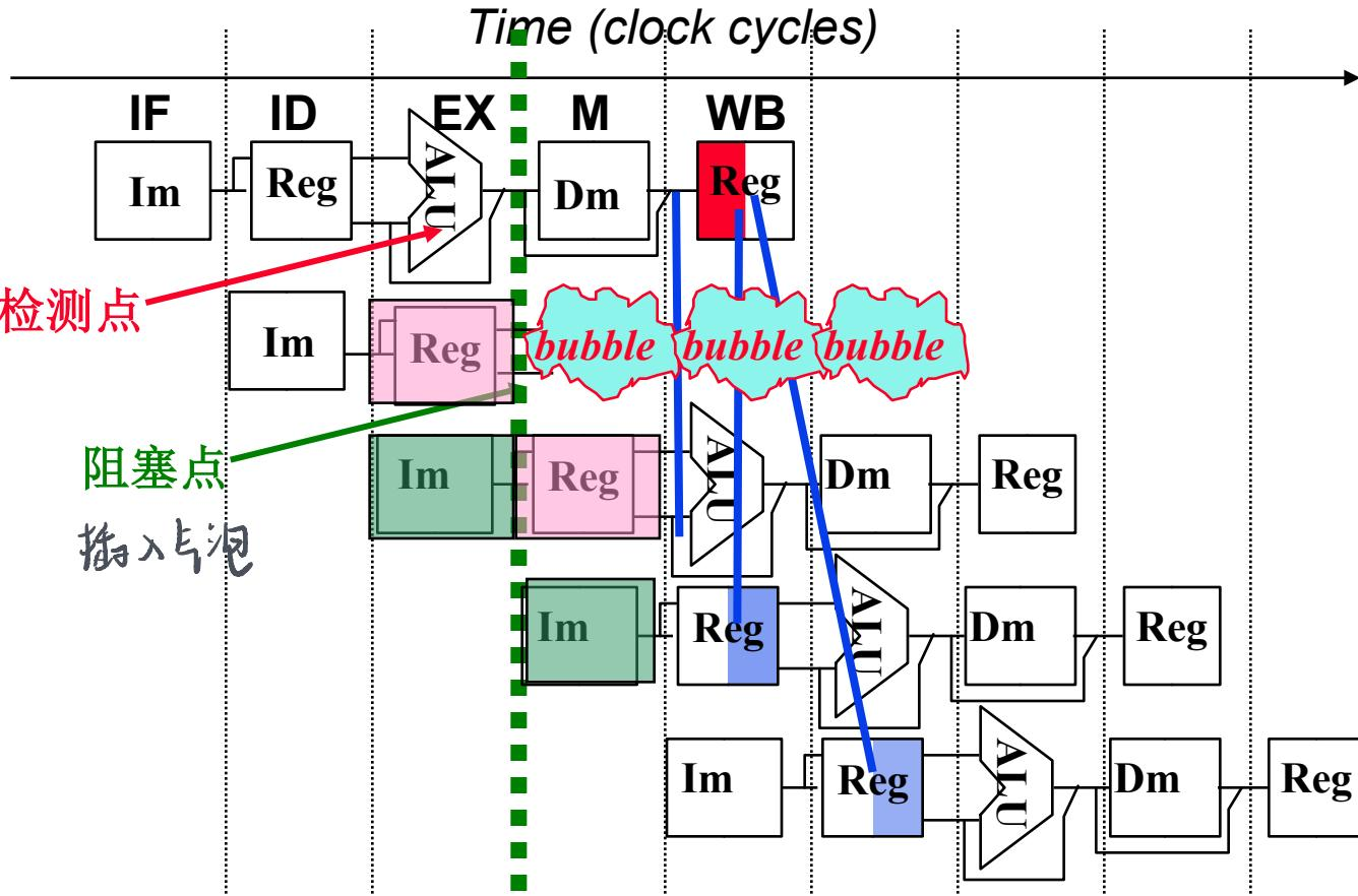
在阻塞点，将load后面两条指令的执行结果清除，并延迟一个周期执行
