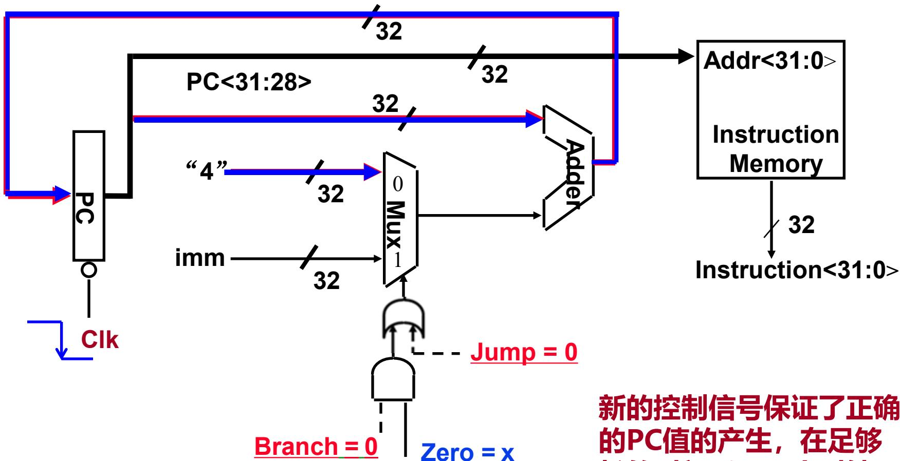
新的控制信号保证了正确的PC值的产生，在足够长的时间后，下个时钟Clk到来！
